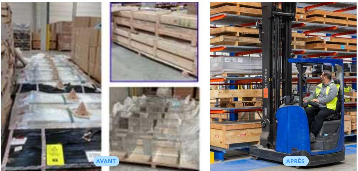
Les « pièces masses » sont des pièces dont le stockage est non-éligible en palletier standard. Auparavant stockées au sol ou empilées sur hauteur limitée, elles reposent désormais sur des **cantilevers** : rayonnages conçus pour le stockage de charges de dimensions encombrantes et non standards, optimisant ainsi la hauteur disponible.
